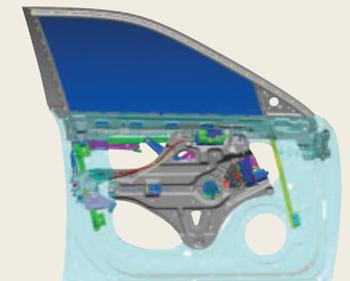
スチール・フレームドアモジュールのドア搭載状態
