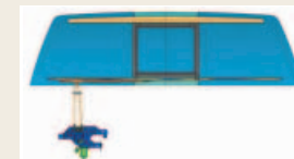
モーターとケーブルがバランスよく運動して後部ガラスを開閉させます
