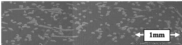
チタン線幅50 \mu\text{m} で空隙率87%のTWの断面SEM像
